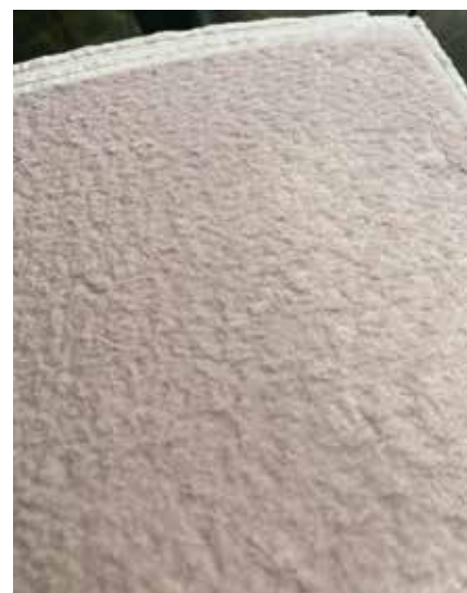
Bild 2. Filterskiva av cellulosa till plattfilter efter användning. Vinet måste gå igenom filtret och med tiden byggs det upp ett lager av material som filtrerats bort på skivans yta. Till slut kan flödet genom filtret bli mycket lågt. Man får se till att ha tillräckligt stor sammanlagd yta för att klara hela volymen innan det sker.
