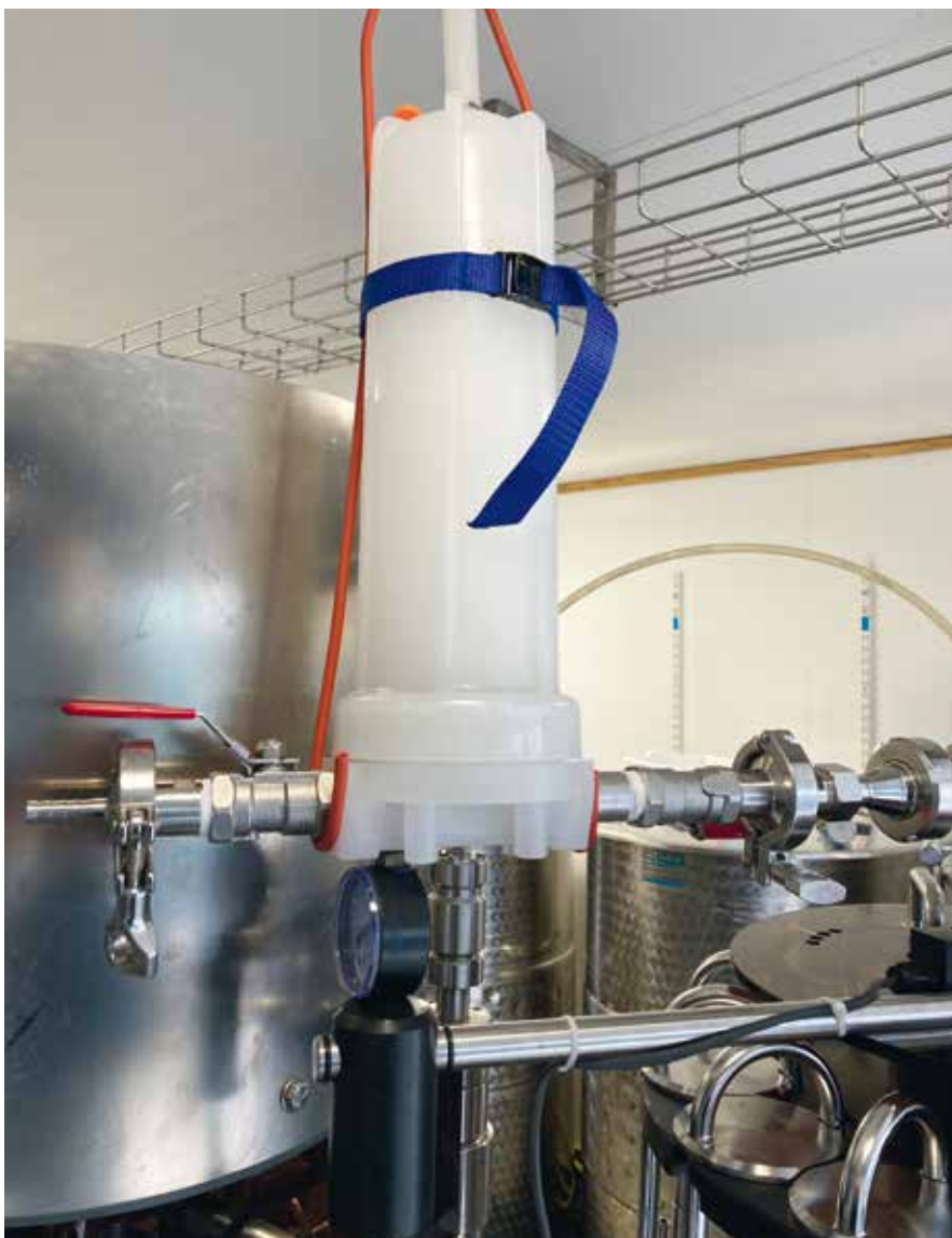
Bild 6. Buteljering med absolut 10" membranfilter 0,45 µm. Filtret (cartridgefilter) sitter monterat i sitt filterhus som placeras före inloppet av buteljeringsmaskinen.
